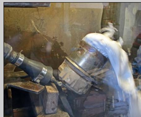
Durant le second cycle du nettoyage, l'eau et l'air sont injectés en sens inverse de celui de la circulation des gaz d'échappement afin de décoller et évacuer les cendres. S'ensuit une longue période de séchage, indispensable pour éliminer toute humidité à l'intérieur du filtre.
