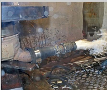
Le premier cycle du nettoyage ne dure que quelques minutes au cours desquelles de l'eau et de l'air pulsé sont injectés dans le sens de circulation des gaz d'échappement.
