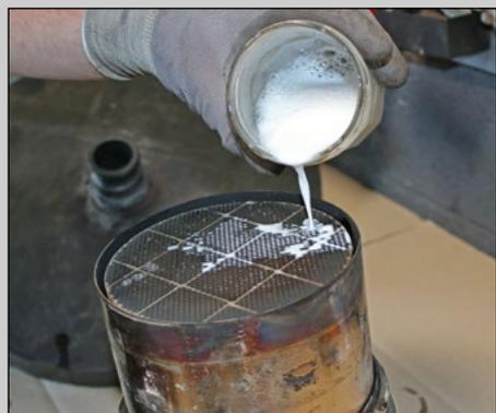
Après avoir été inspecté visuellement, le nettoyage du Fap commence toujours par l'ajout d'un dégraisseur bio dans le filtre afin de dissoudre et décoller les cendres.
