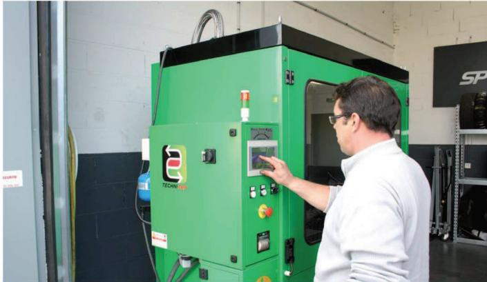
◀ Entièrement automatisée, la machine assure le lavage, le séchage et les précieuses mesures de contre-pression du filtre avant et après son traitement.
